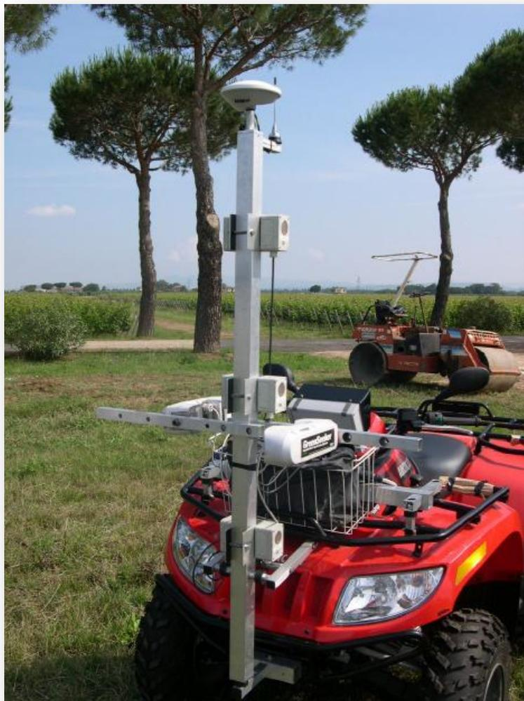
*Figura 6: Quad attrezzato per l'esecuzione dei rilievi in vigneto: lungo l'asta verticale sono stati posizionati i differenti sensori adottati per la prova ed alla sua sommità l'antenna del GPS differenziale.*
