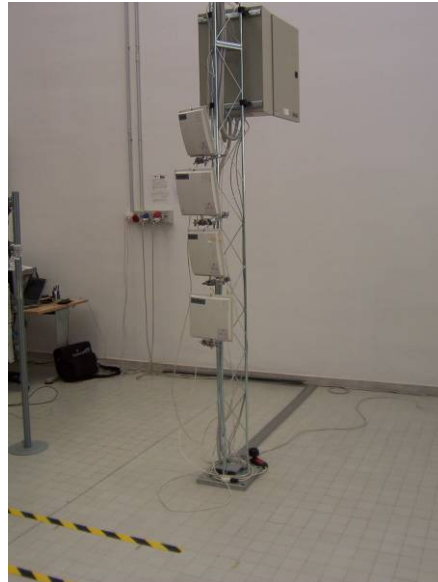
Figura 14: varco con 4 antenne disposte sullo stesso lato
