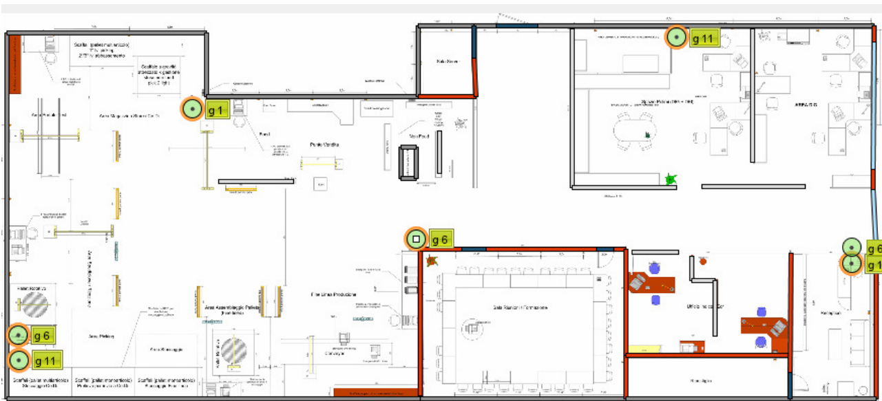
Figura 28: collocazione access point nell'EPC Lab (i "g6" ai lati in realtà rappresentano il canale su cui i due access point adiacenti comunicano via bridge, tecnicismo che in questo momento non è necessario approfondire)
