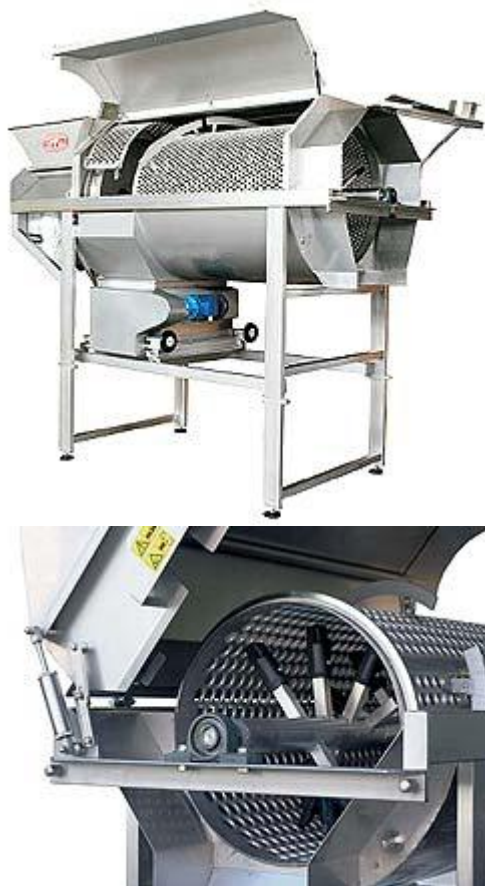
Fig. 3 Diraspatrice IMMA RPD 1/2 e dettaglio del buratto e dell'aspo battitore
