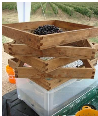
Fig.9 Disposizione dei setacci per la separazione del MOG dagli acini
