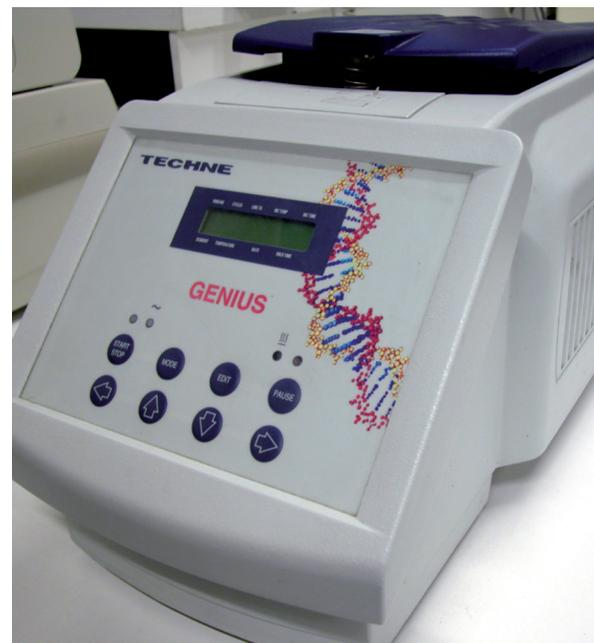
Il termociclatore, strumento all'interno del quale si svolgono le fasi della PCR.
